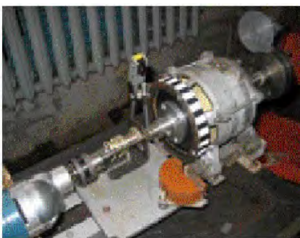
Стенд для сравнительных испытаний торсиографов СКАН и ЦНИИ Крылова
