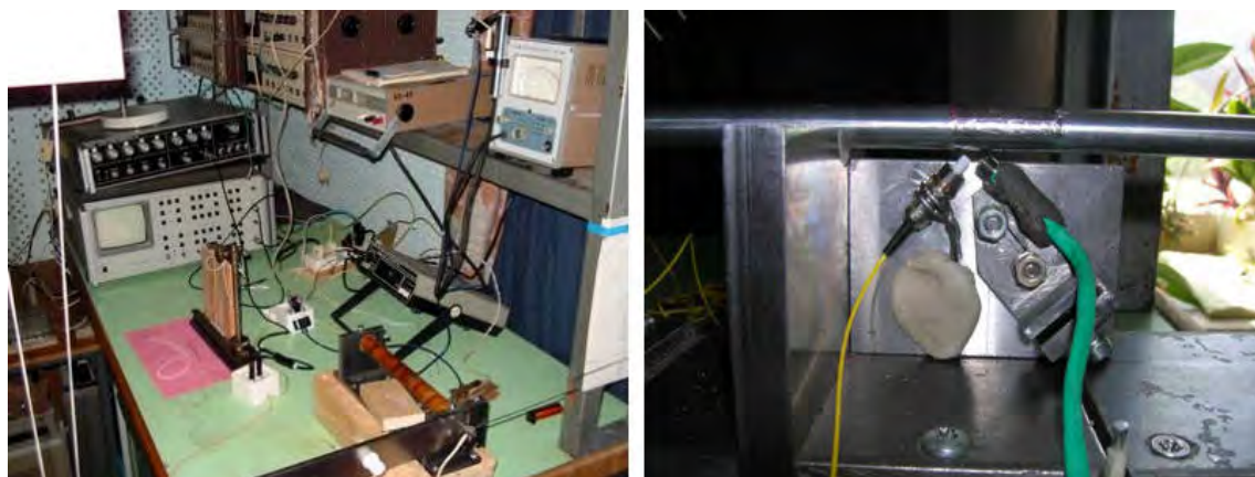
Стенды для испытаний бесконтактного способа измерений скручивания вала
