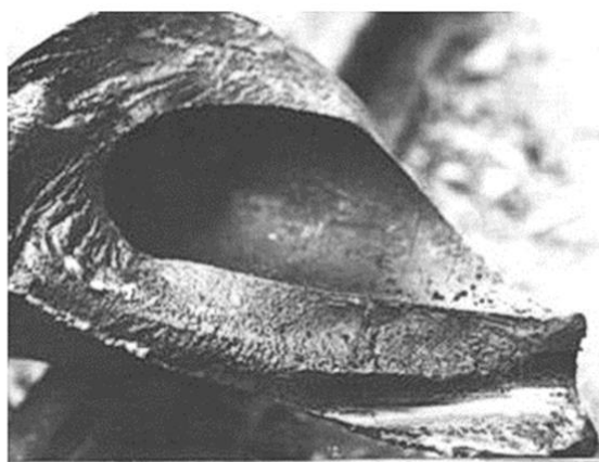
Поломка гребного вала на судне «Сатурн»
