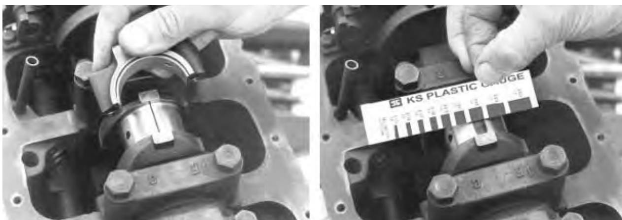
Рисунок 34 Принцип измерения методом выжимки
