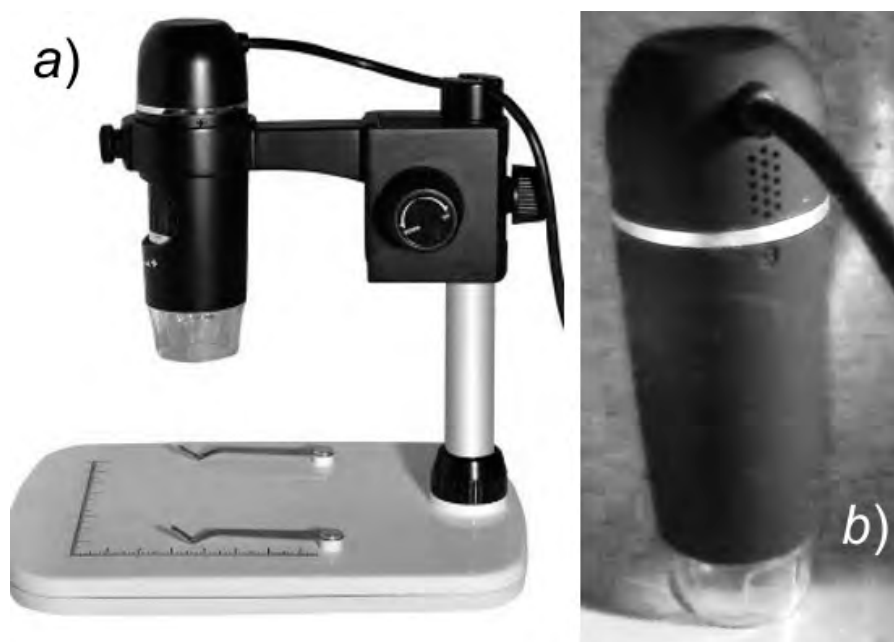
Рисунок 41. Микроскоп DIGMICROPROF (a) и веб-камера на объекте (b)
