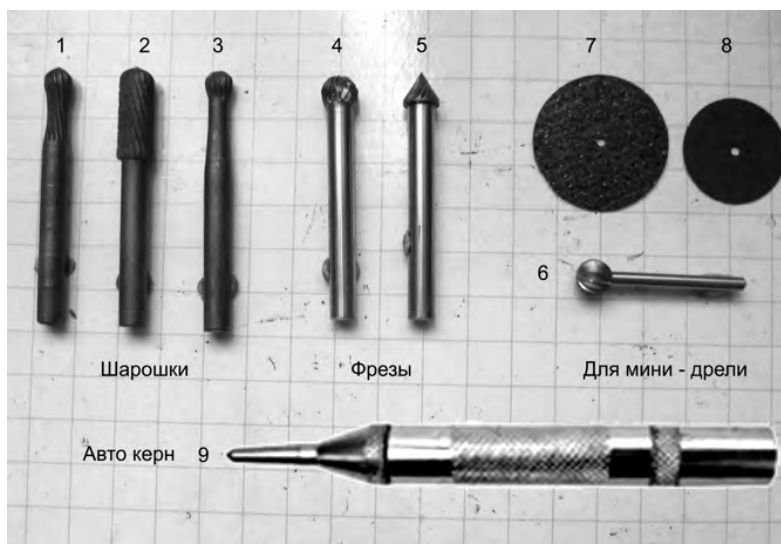
Рисунок 45 Инструменты для создания лунок. Шарошки: 1 – с вершиной 100^\circ , 2 – с вершиной 118^\circ , 3 – шарообразная 6 мм. Фрезы: 4 – шарообразная 8 мм, 5 – конус 60^\circ . Для мини-дрели: 6 - шарообразная фреза 7.8 мм, 7 - отрезной диск 32 мм, 8 - отрезной диск 24 мм. 9 – автоматический керн с конусом 90^\circ
