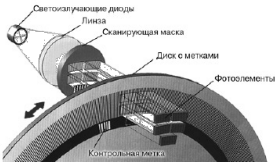
Рисунок 99 Устройство и внешний вид оптического энкодера.
