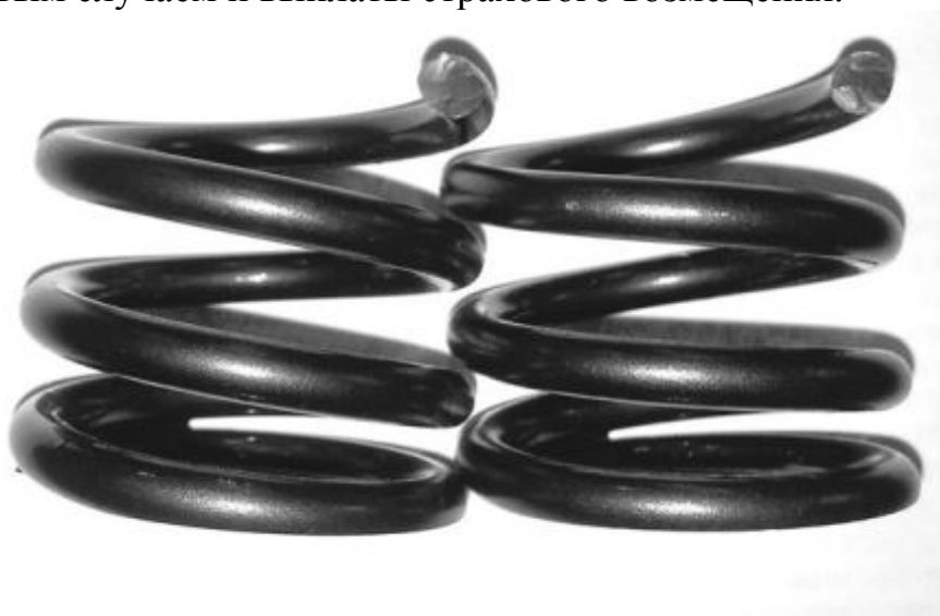
Рисунок 91 Разрушенная пружина выхлопного клапана
