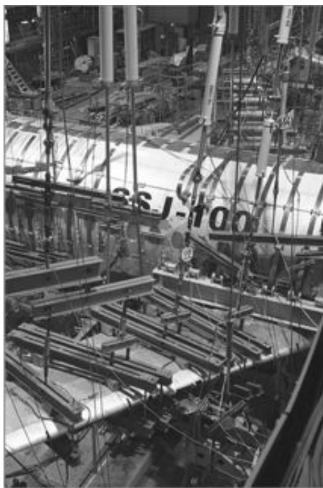
Рисунок 1-6. Статические испытания "Сухой Супер Джет-100" в ЦАГИ
