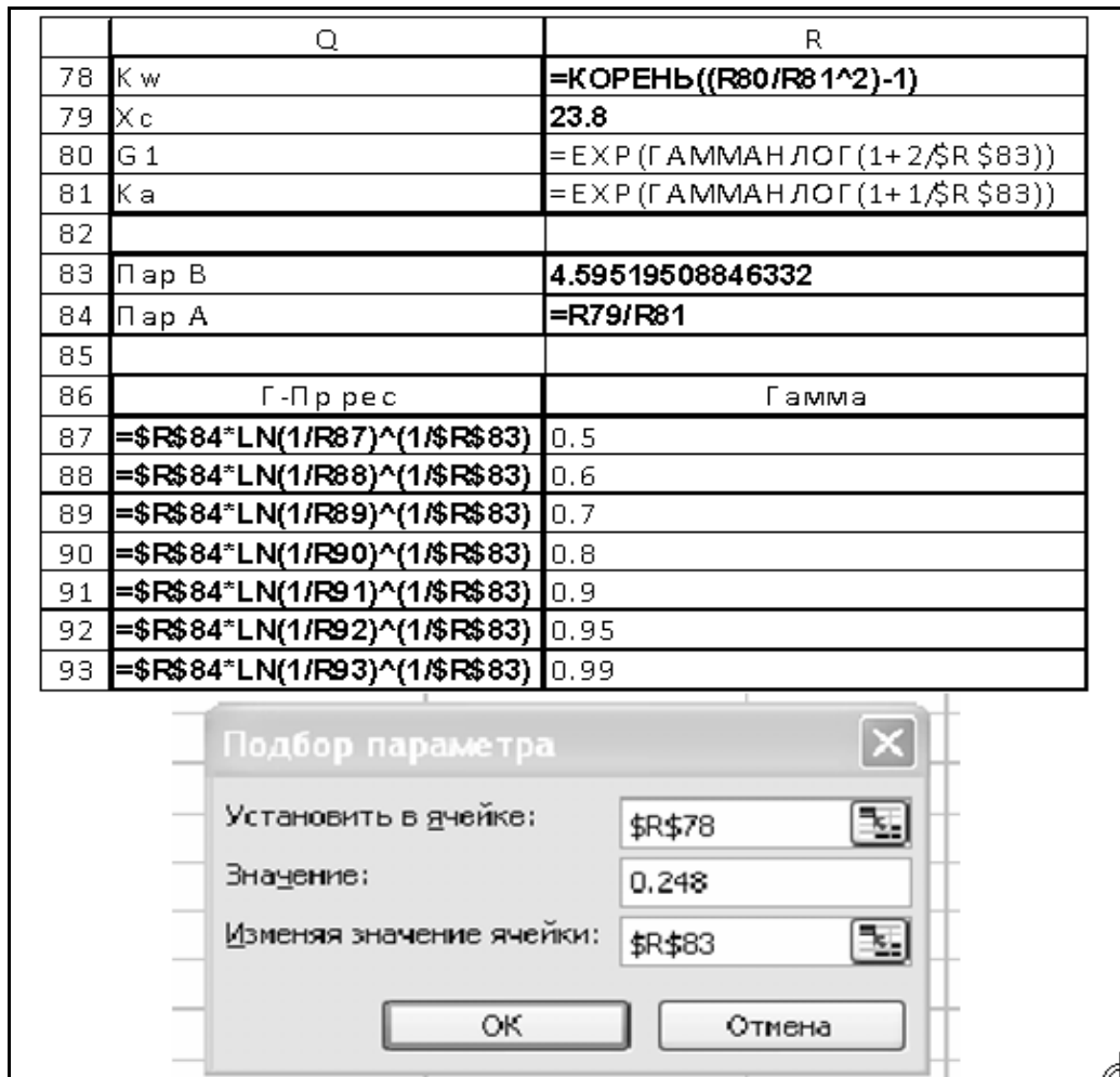
Рисунок 5-4 Программы определения параметров распределения Вейбулла и гамма – процентного МКИ в редакторе EXCEL
