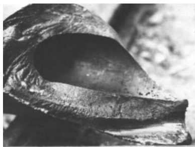
Рис. 1-5 Пример поломки гребного вала из-за крутильных колебаний
